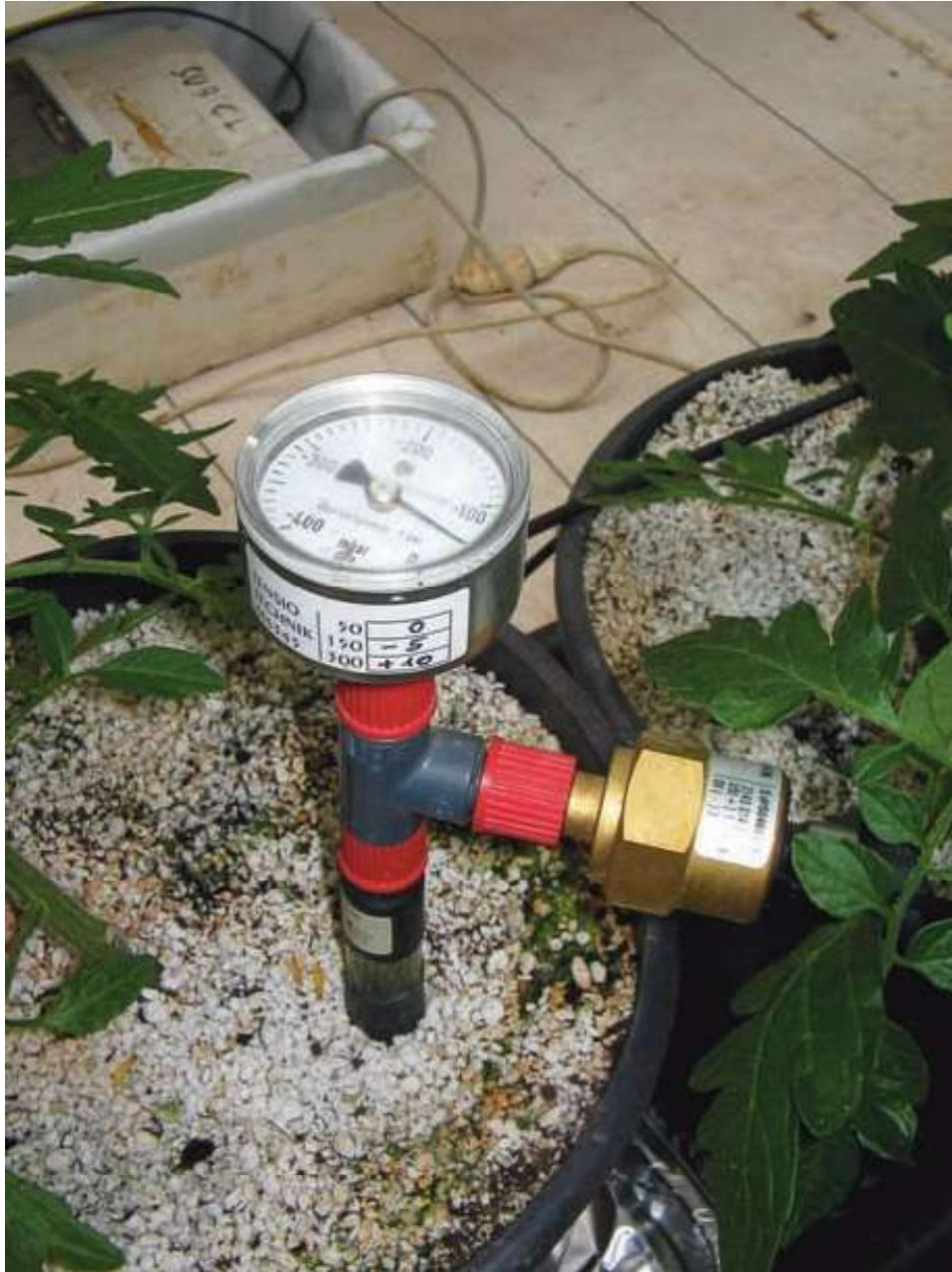
Foto 2 – Particolare di un tensiometro inserito in un vaso e dotato di sistema per l'automazione dell'intervento irriguo (tensioswitch).
